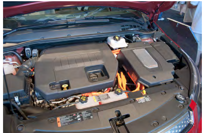
Kuva 2. Euroopassa valmistettujen sähköajoneuvojen korkeajännitejohdot ovat oranssin väriset (InSapphoWeTrust 2011)
