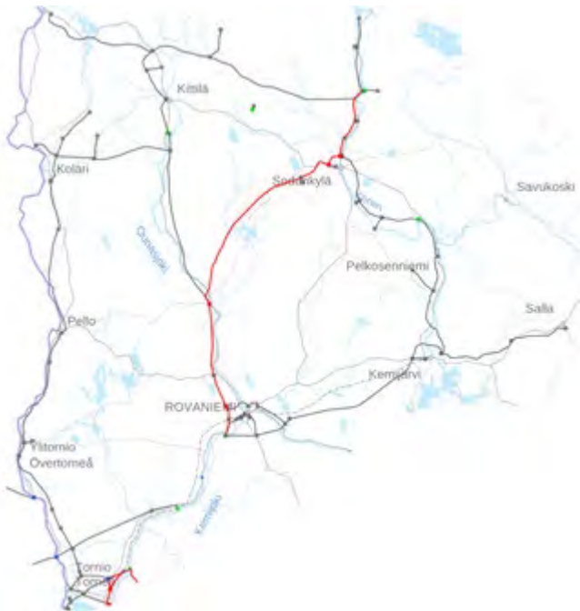
Kuva 1. Lapin kantaverkko. Fingridin 110 kV:n verkko on piirretty punaisella, muiden mustalla. Kuvasta on poistettu 220 kv:n kantaverkon osuudet.
