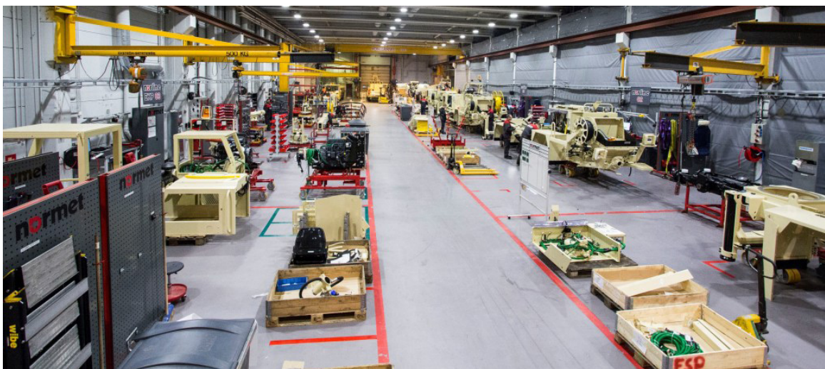
Kuva tuotantolinjasta. Varsinainen kokoonpanolinja on käytävän oikealla puolella. Kunkin kokoonpanopisteen kohdalla käytävän vasemmalla puolella on puolivalmisteita tuottava esikokoonpanopiste.
