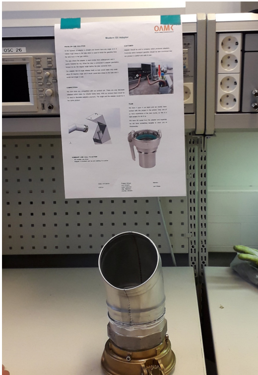
Uudentyyppinen huoltoaseman polttoainesäiliön täyttösullake.
