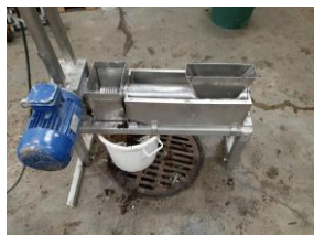
Neste-kiintoaine-erotusta on tehty mm. ruuvilla. Kuva: VTT
