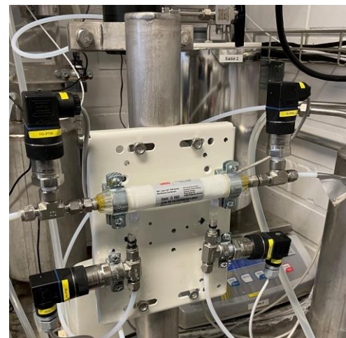
Metaanin ja hiilidioksidin erotusta membraanikontaktorilla labrakokoluokassa. Kuva: VTT
