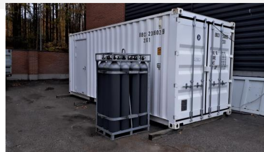
Hiilidioksidin puhdistus-, paineistus/nesteytys-, ja pullotuslaitteisto on sijoitettu merikonttiin. Kuva: VTT
