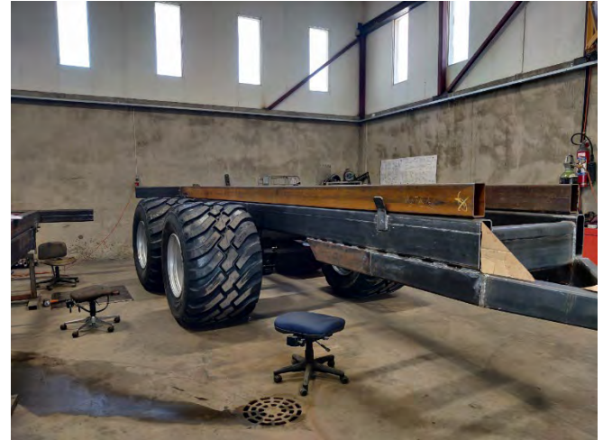
Kuva 2. Monikäyttöinen omavalmisteinen perävaunun alusta.
