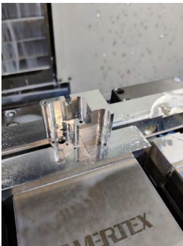
Kuva 3. Tarttujan rungon koneistaminen.
