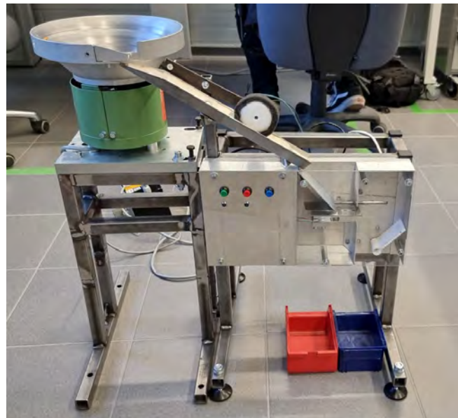
Kuva 3. Teräpalojen lajittelijan prototyyppi.
