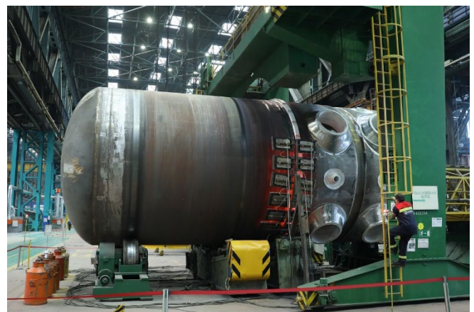
Kuva 1. Reaktoripainesäiliön valmistusta (World Nuclear Association 2020)
