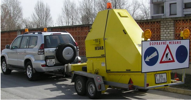
Kantavuusmittauksissa käytetty Kuab FWD-50 –pudotuspainolaite.
