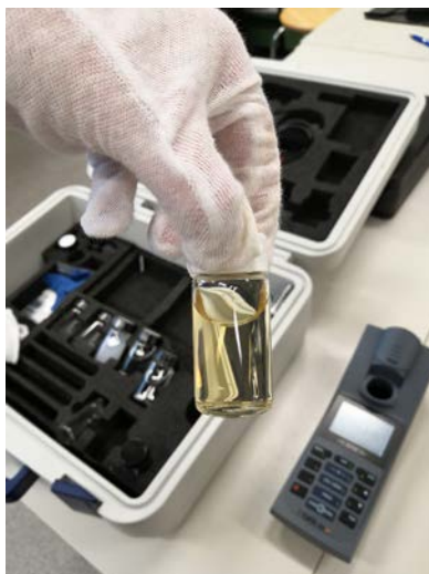
Veden sameuden mittaamista sameusmittarilla. Kuva: Laura Sihvonen
