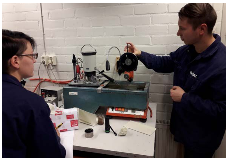
Bitumin tunkeuman määrittämlaitetta valmistellaan mittauksia varten.
