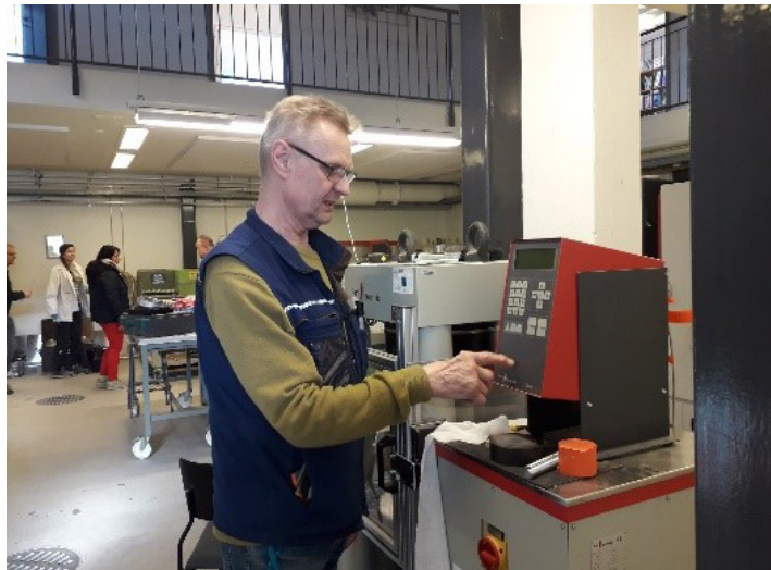
Esa Perälä testaa betonin puristuslujuutta Toni 3 000 kN -laitteella.
