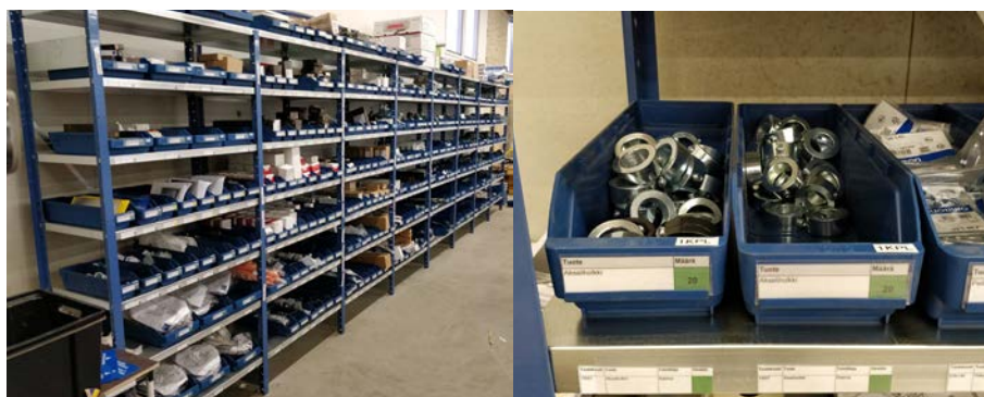
POTKUA-hankkeen yhteistyöyritykselle opinnäytetyönä toteutettu varastoratkaisu, joka pohjautuu 2-laatikkoperiaatteeseen.
