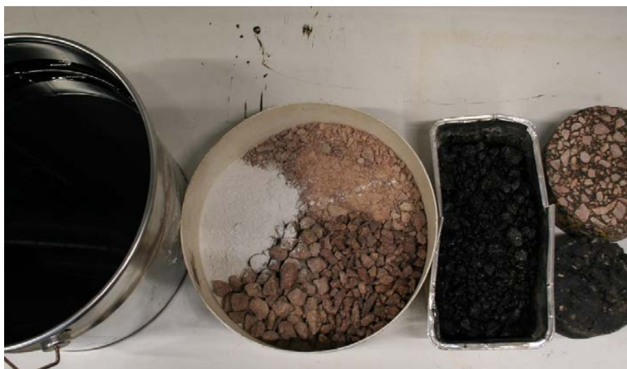
Asfaltin valmistuksessa tarvitaan bitumia, kiveä ja filleriä. Kuvassa näkyy myös valmiista asfalttimassasta valmistettuja koekappaleita.
