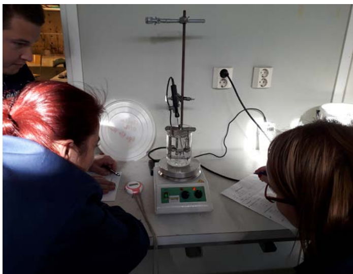
Lämpötilan vaikutus bitumin pehmenemispisteen konkretisoituu laboratorioharjoitusten avulla
