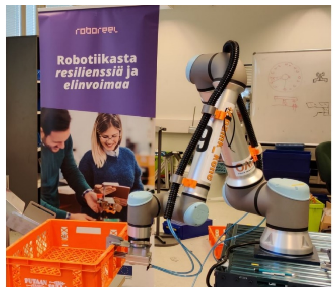
Kuva 1. Oamkin koneautomaation laboratorioissa UR-10-robotisolu valmiina tehtävään
