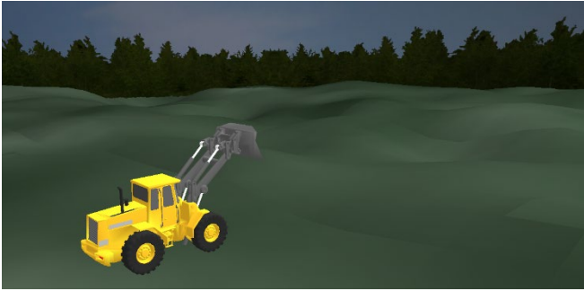
Kuva 3. Pyöräkuormaaja virtuaalimaailmassa (Mevea Solver)
